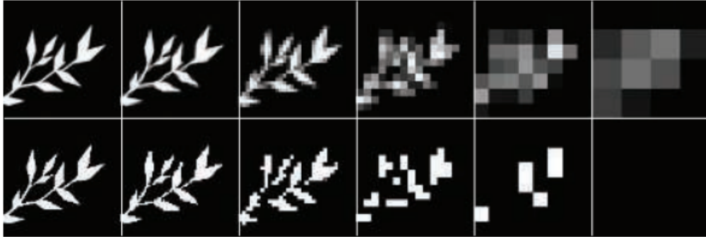
图 6.30：第一行是叶子图案不同 mipmap 层级的结果，更高的 mipmap 层级放大了叶子的可见性。在第二行中，mipmap 进行了阈值为 0.5 的 alpha 测试处理，这个过程展示了随着物体与相机距离的增加，其在屏幕上占据像素数量越来越少。[557]
