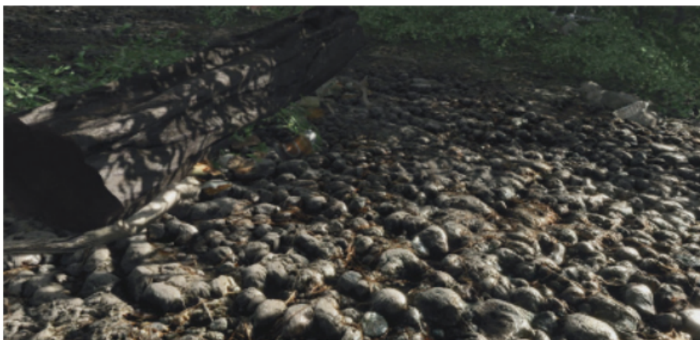
图 6.42：视差遮挡映射，又名浮雕映射，将其应用在石径上，可以使得石头看起来更加真实。图中的石径地面实际上是一组简单的三角形，外加一个高度场。
