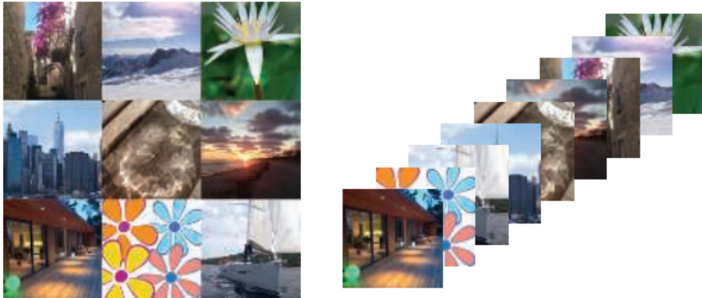
图 6.20：左图：纹理图集，其中 9 个较小的图像被组合为一个纹理。右图：一种更加现代的方法是将较小的图像设置为纹理数组，大多数现代 API 中都有类似的概念。
