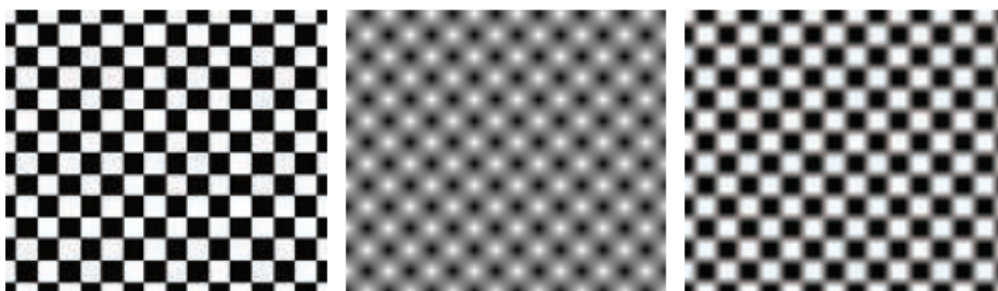
图 6.10：从左到右分别是邻近过滤，双线性插值，和部分重新映射的结果，原本的纹理是一个 2 \times 2 的黑白棋盘格。需要注意的是，由于纹理和图像网格并不是完美匹配的，因此邻近过滤方法所生成的正方形大小略有不同。
